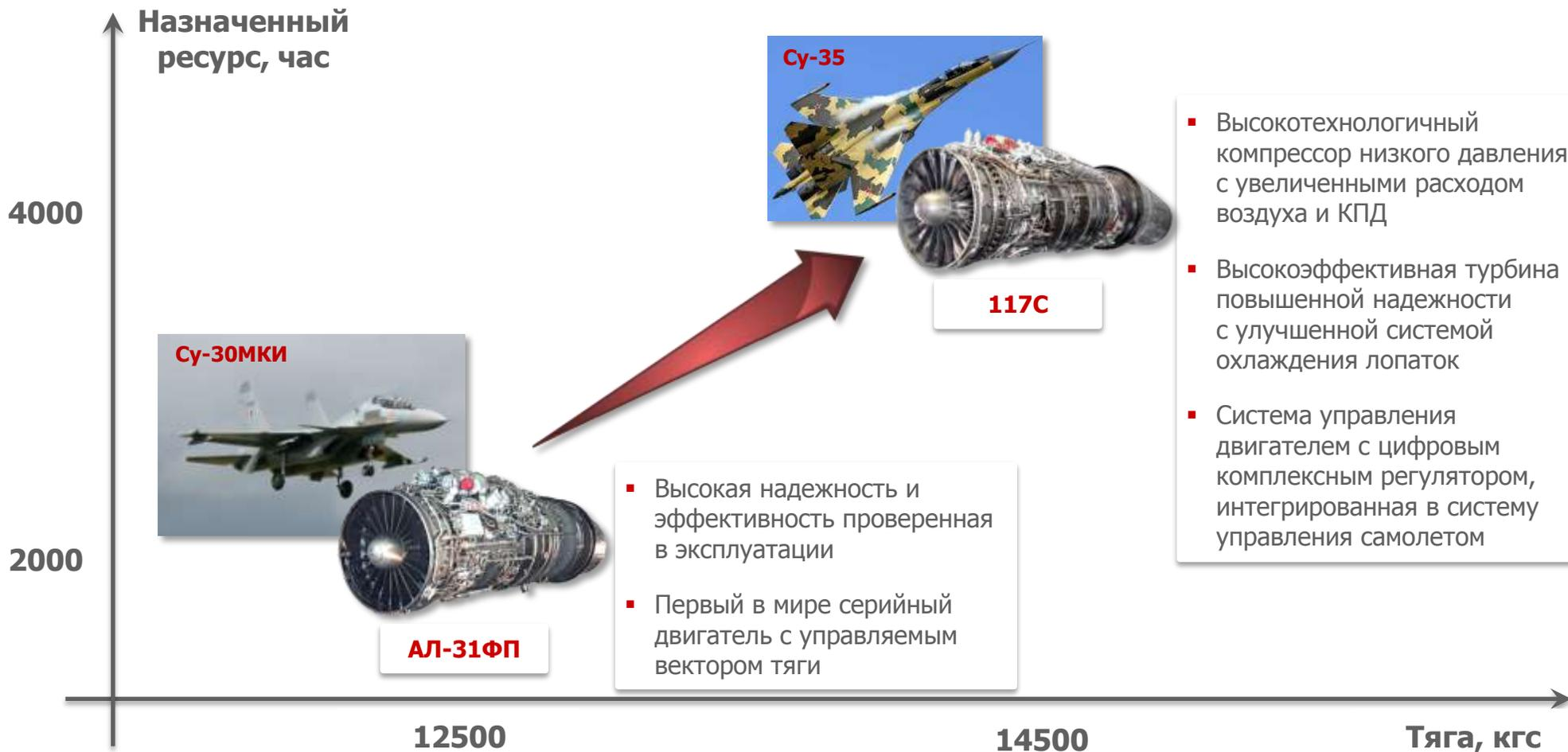
Преимущество конструкции, проверенной в эксплуатации, в сочетании с технологиями нового поколения
