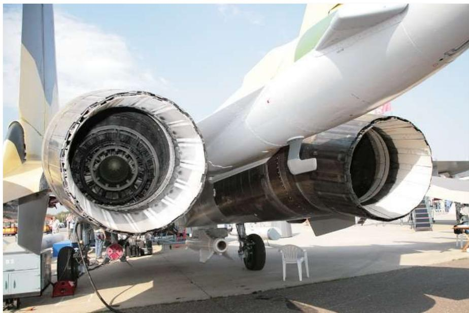
**Двигатель 117С создан для многофункционального истребителя Су-35 разработки АХК Сухой**
